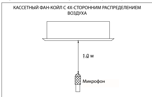
Рисунок №6 Схема испытаний шумовых характеристик агрегатов
