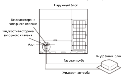
Рисунок 3-5.14. Испытание на газонепроницаемость
