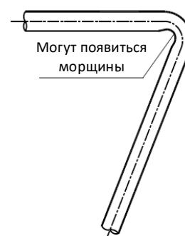
Рисунок 3-5.3. Сгибание труб более чем на 90°
