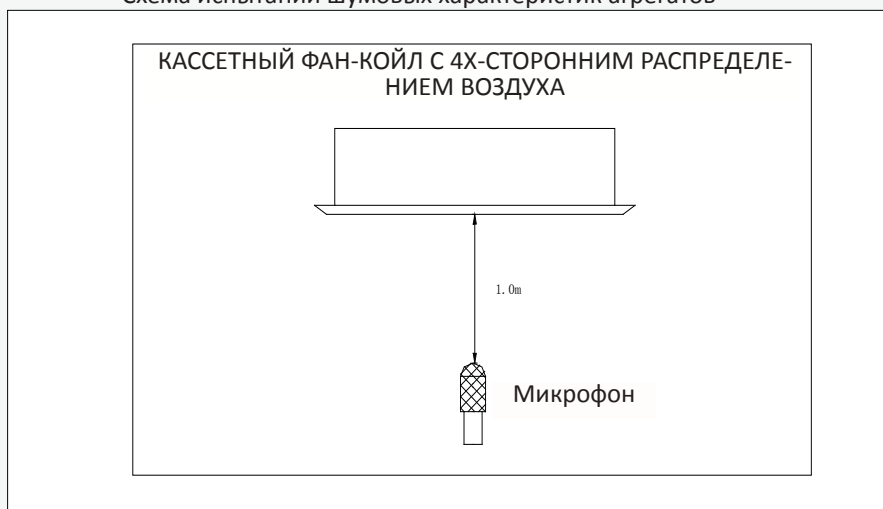
Схема испытаний шумовых характеристик агрегатов
