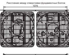
4-15x22,5mm - Овальное отверстие - Отверстие под фундаментный болт
