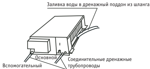
Рис. 7.4. Проверка слива воды
