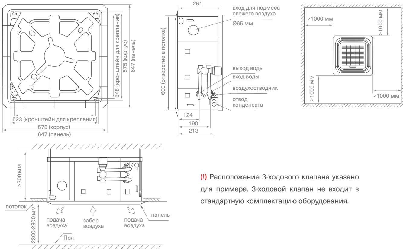
(!) Расположение 3-ходового клапана указано для примера. 3-ходовой клапан не входит в стандартную комплектацию оборудования.
