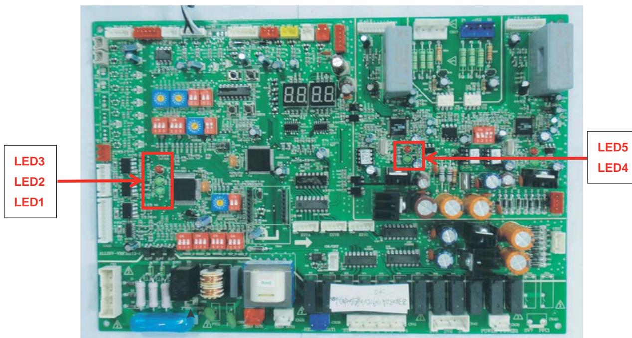
LED1: индикатор электропитания. Светится при подаче на блок электропитания.
