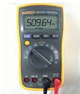
Переключите диапазон измерений мультиметра на 1 кВ и измерьте напряжение между двумя электролитическими конденсаторами.
