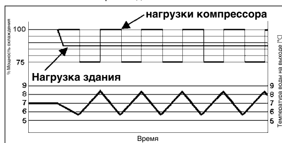
Неустойчивость EWLT с шаговым регулированием производительности (4 ступени)
