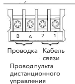
Увеличенный вид проводниклеммной коробки(ТВ), деталь P
