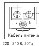
Увеличенный вид проводниклеммной коробки(ТВ), деталь P
